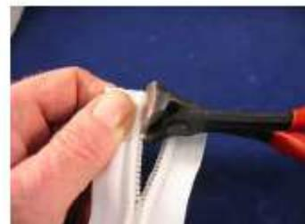
Ca. 5 cm nach dem gesetzten Stopper den übrigen Reissverschluss abschneiden. Nun die übrigen Spiralen vom Reissverschluss-Ende bis zu den Stoppern entfernen. Dazu mit dem Daumen die Spirale zur Mitte hin drücken und mit einem Frontschneider (Kneifzange mit geradem Schnitt vorne) die Spirale bis zum Trägergewebe hin abzwicken. Anschließend mit einem Stecker die an der Kette verbliebenen Spiralhälften Stück für Stück herausziehen.
